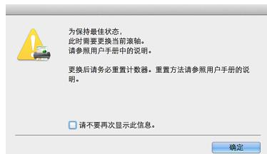
如果启动时出现此消息，请购买一套更换滚轴工具包，用工具包（送入滚轴和减速滚轴）中包含的消耗品更换已磨损的部件。有关更换滚轴工具包的详细信息，请参阅第 76 页。
