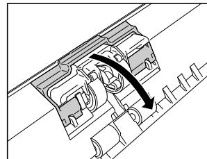
**2 拉动将减速滚轴固定到扫描仪的固定杆左侧，然后拆下滚轴。**
